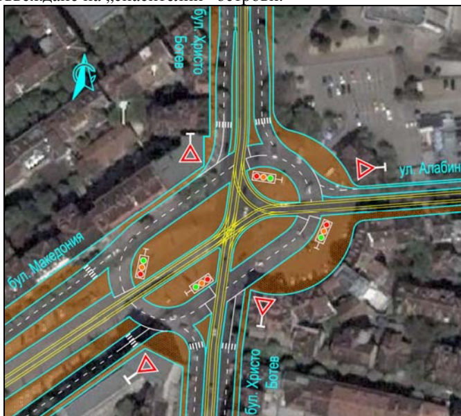
фиг. 6 – Идеен вариант за въвеждане на кръгово движение с цел подобряване на експлоатационните характеристики на кръстовището.
