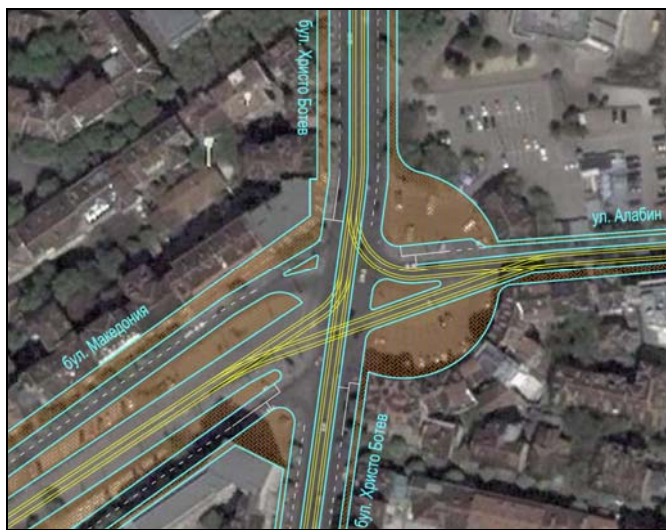
фиг. 5 – Съществуващо светлинно-сигнално регулирано кръстовище на пл. „Македония”, гр. София. Сложната геометрия и големият брой трамвайни връзки създават сериозни затруднения за движението.
