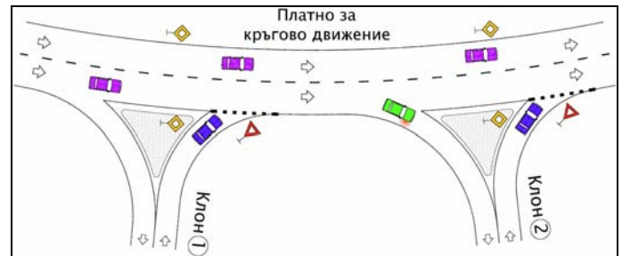
фиг. 1 – Кръговото кръстовище може да бъде разглеждано като серия от близко разположени „Т”-кръстовища
